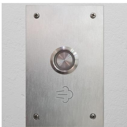
Монтажная пластина закрепляется на стене на четыре подходящих самореза. Саморезы в комплект поставки не входят. При необходимости используйте силиконовый герметик для гидроизоляции пластины.
