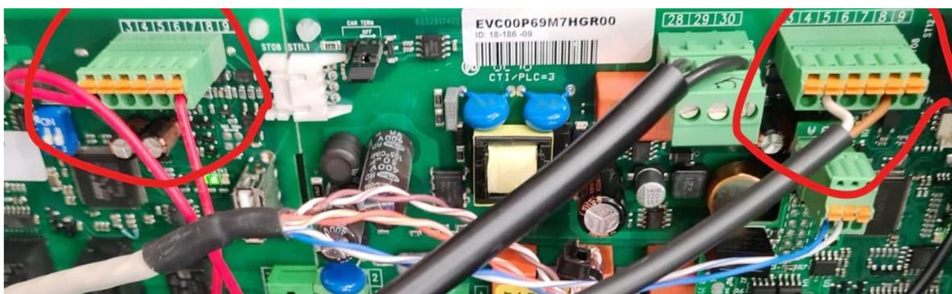
Если цифровой вход (клемная колодка ST08, клеммы 3 и 8) на системной плате занят, то можно использовать цифровой вход на доп. плате Спа опций ST05.
